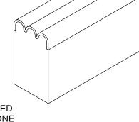
**FACTORY APPLIED** & CURED SILICONE **BELLOWS WEATHER FACING**
