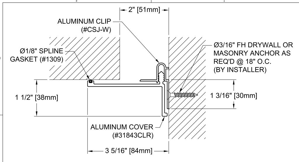
INTERIOR SURFACE SNAP-ON CORNER WALL & CLG. SYS.
